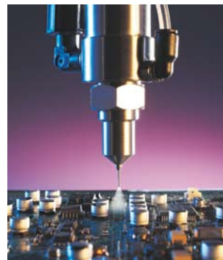
• Spruzzo selettivo TS5540-MS, TS566R , serbatoio
