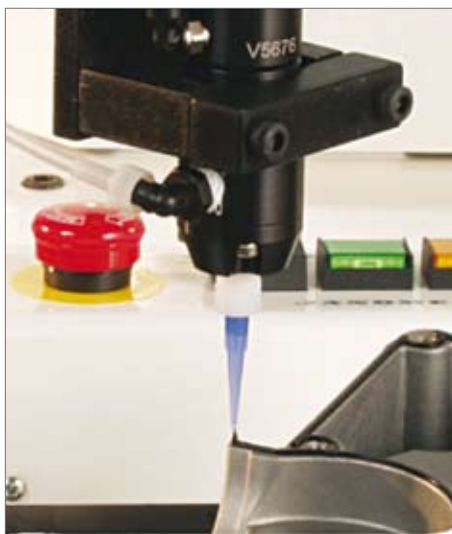
• Formazione di guarnizioni TS350, TS5322 , pompa
