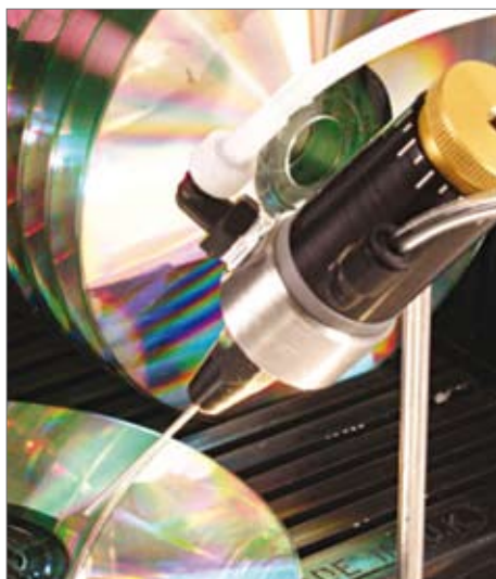
• Applicazione di coating TS5622VU -DVD, TS566R , serbatoio
