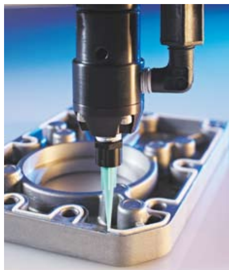
• Sigillatura TS5322, TS555R , serbatoio
